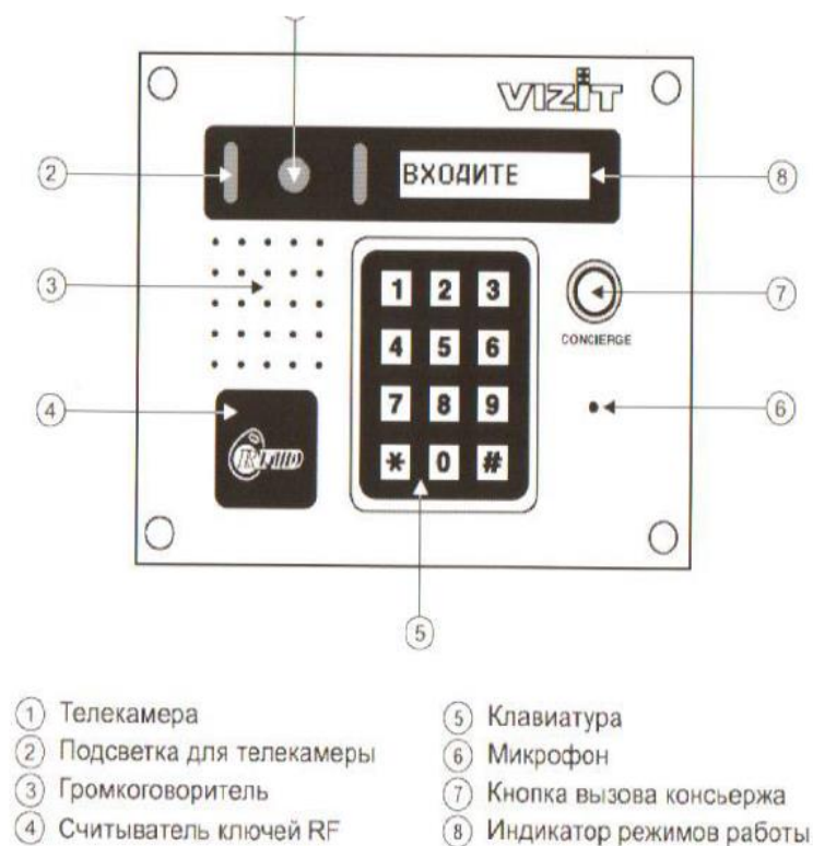
Рис. 5 Внешний вид и органы управления блока.
