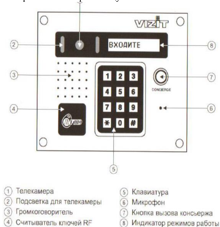
Рис. 5 Внешний вид и органы управления блока.
