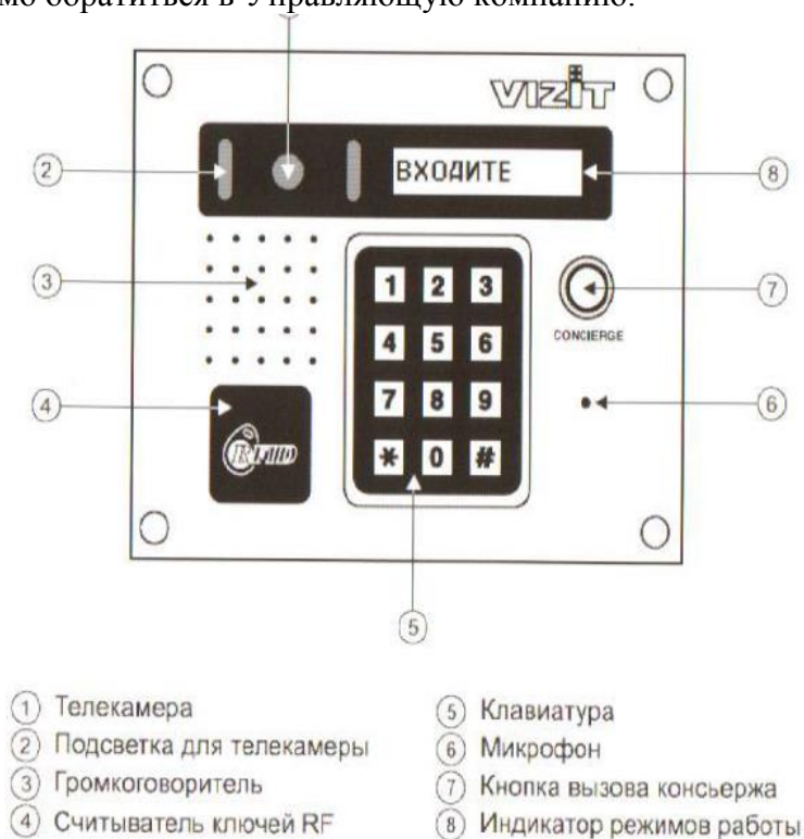
Рис. 5 Внешний вид и органы управления блока.
