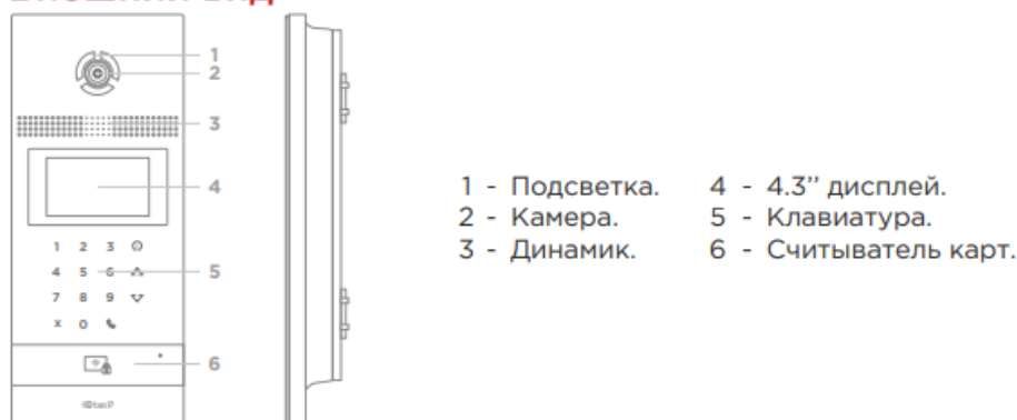
Рис. 5. Внешний вид и органы управления блока BAS-IP AA-12FB.
