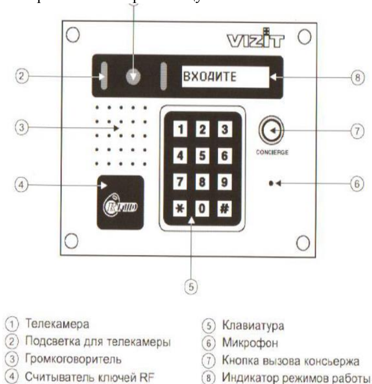
Рис. 5 Внешний вид и органы управления блока.
