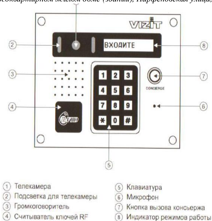
Рис. 5. Внешний вид и органы управления блока «VIZIT».
