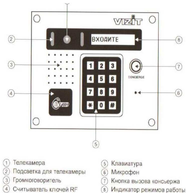
Рис. 5 Внешний вид и органы управления блока.
