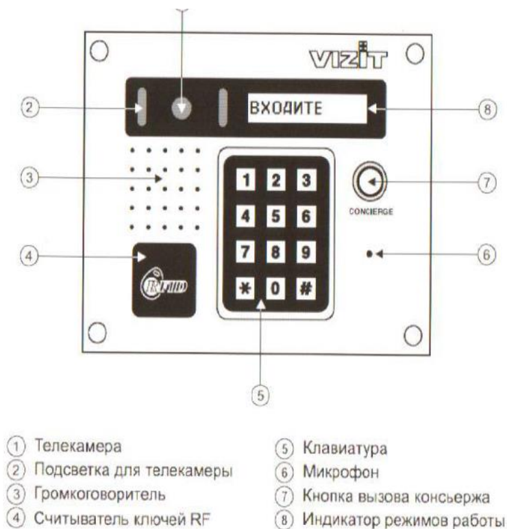
Рис. 5 Внешний вид и органы управления блока.
